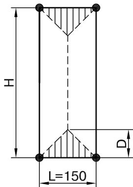
На рисунке показана схема установки ригеля в витраж
