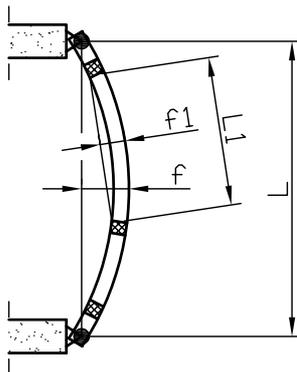
На рисунке показан вариант, когда на стойку закреплённую с шагом - L устанавливаются несколько стеклопакетов. L1 - размер стеклопакета.
