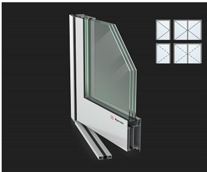
Двери Xpress Maxi — это система с повышенным вниманием к вопросам теплоизоляции помещений и удобству эксплуатации. В её основе — комбинация из двух алюминиевых профилей, соединённых между собой полиамидной термовставкой, длина которой 20 мм.
