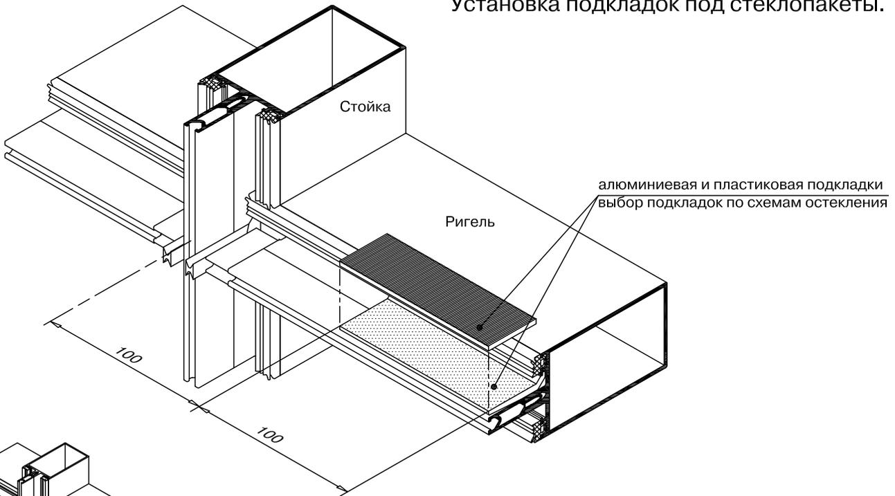
на алюминиевую подкладку наносится герметик для фиксации на ней пластиковой подкладки.
