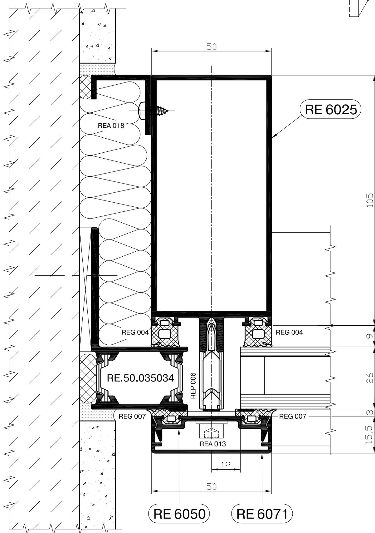
Сечение стойки в области межэтажного перекрытия
