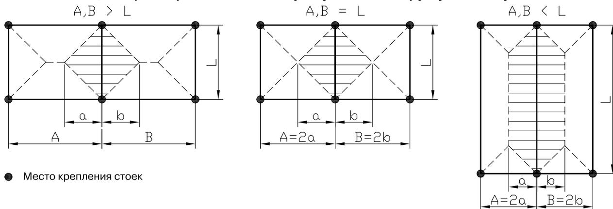
Под воздействием ветровой нагрузки элементы конструкции изгибаются. Расчёт элементов фасада сводится к выбору стоек и ригелей с моментом инерции  $J_x$ , который удовлетворял бы условию:
