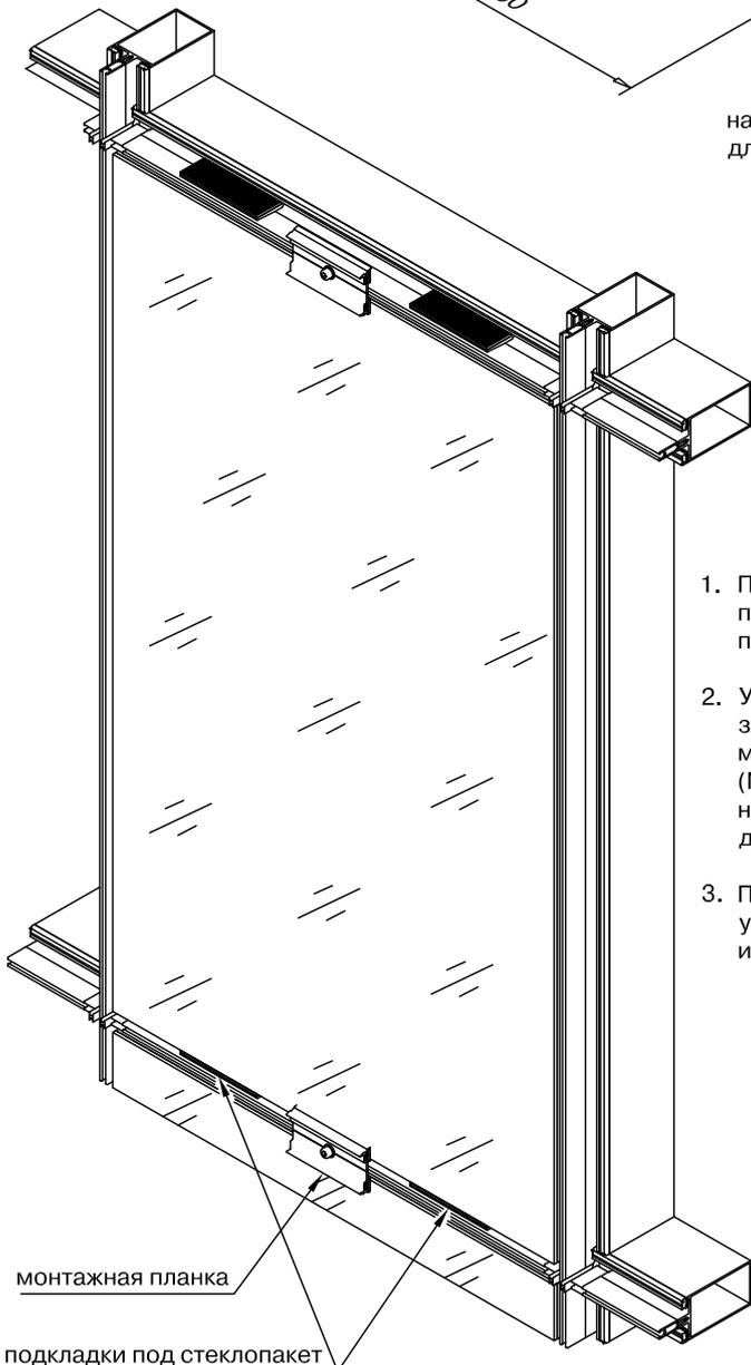
1. Перед монтажом заполнения, по схемам остекления, проверить правильность установки уплотнителей, термовставок и подкладок под стеклопакеты.
