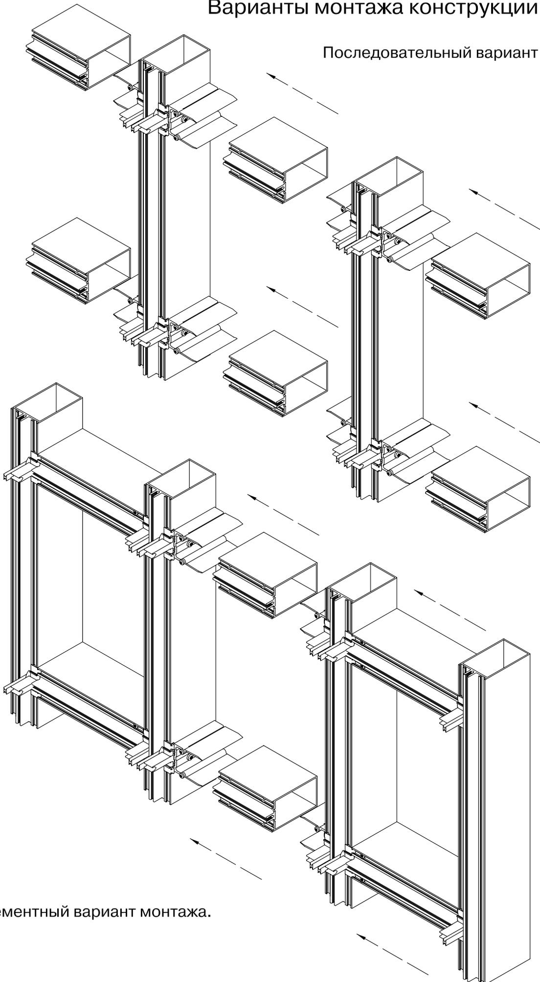
Поэлементный вариант монтажа.
