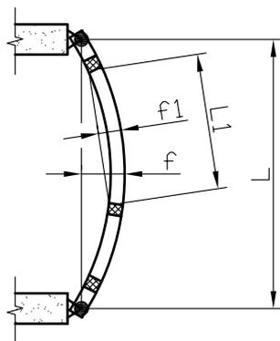
На рисунке показан вариант, когда на стойку закреплённую с шагом - L устанавливаются несколько стеклопакетов. L1 - размер стеклопакета.
