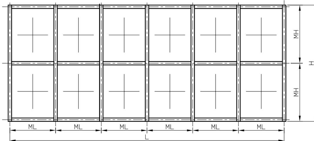
Длина витража  $L = 9000$  мм, и высота  $H = 3500$  мм, расстояние между осями стоек  $ML = 1500$  мм. Средний ригель делит высоту витража пополам  $MH = H/2 = 1750$  мм.
